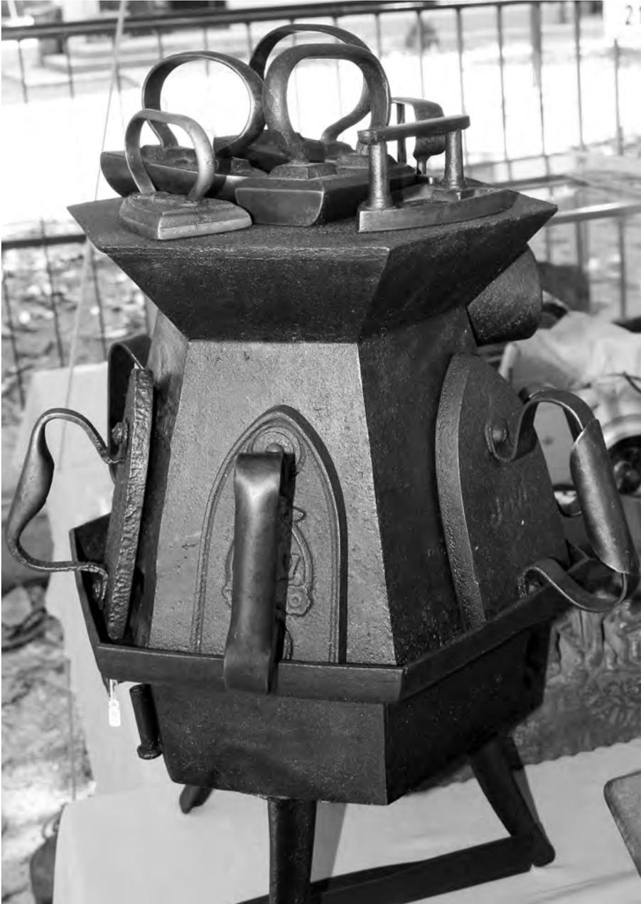
Fig. 5. In tutta la mia vita di “esploratore” di mercatini ho visto solo questo esemplare. La stufa che assolve anche al compito di scaldare i ferri da stiro.
