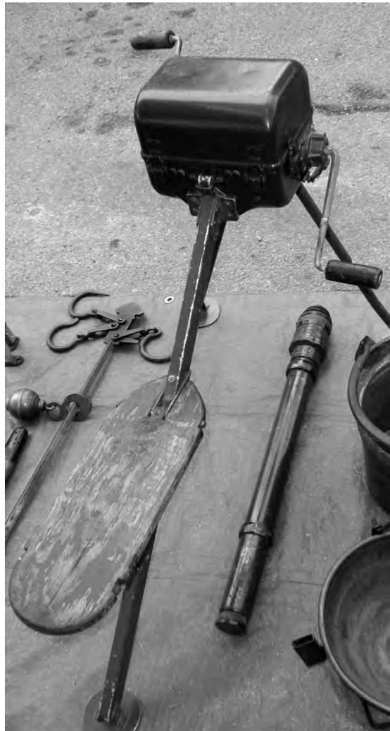
Fig. 2. Una macchina per produrre a braccia (o a piedi) corrente elettrica. In pratica una grande dinamo.
