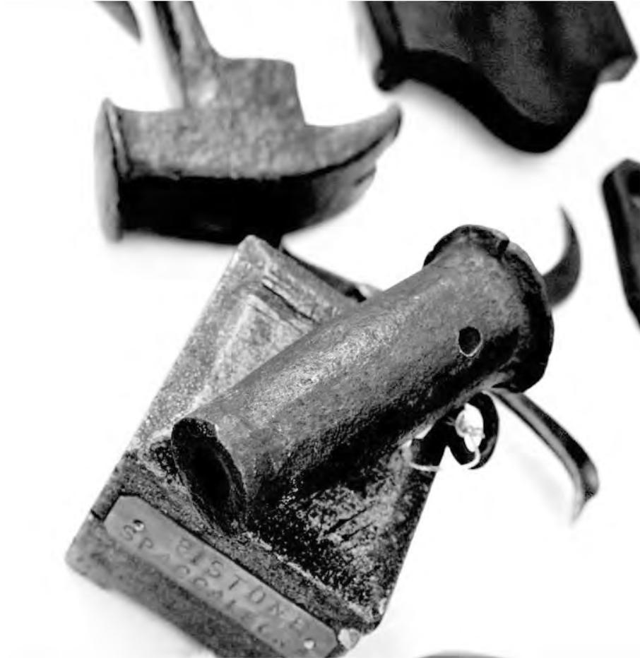
Fig. 14. Un pistone spaccalegna. Lo si conficcava a martellate nel tronco. Poi, attraverso il forellino lo si riempiva di polvere pirica e, con una miccia, si faceva saltare la carica. Visto al mercatino di Fontanellato, nel Parmense. Proveniente dall'Alta val Bidente, nell'Appennino Romagnolo, e in uso fino agli anni Cinquanta.
