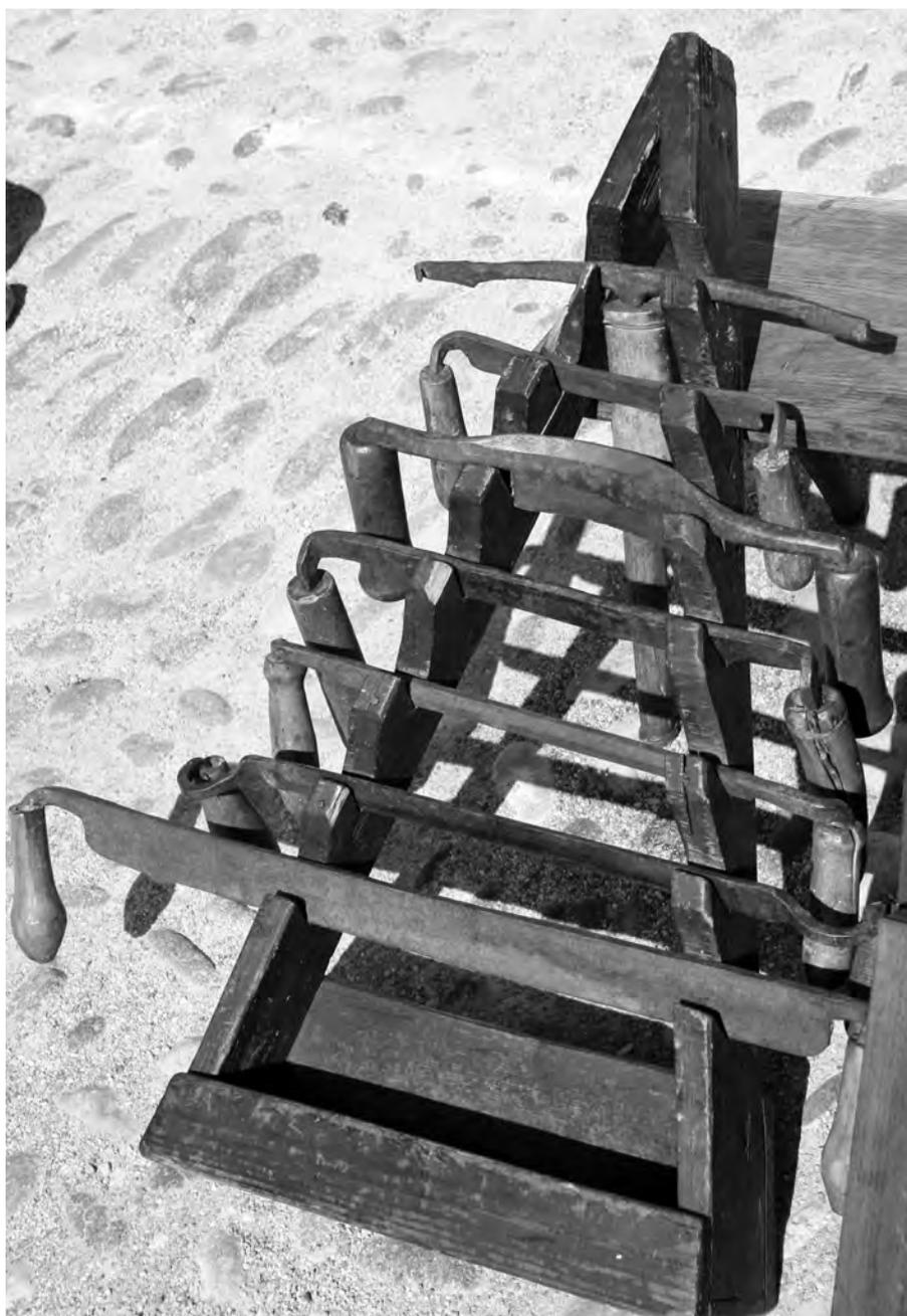
Fig. 8. Un set da bottaio con tutte le misure di taglio per le doghe.
