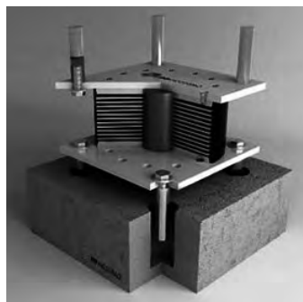
Fig. 7. Isolatori elastomerici con nucleo in piombo, noti anche come Lead Rubber Bearings (LRB) (immagine tratta da FIP industriale).
